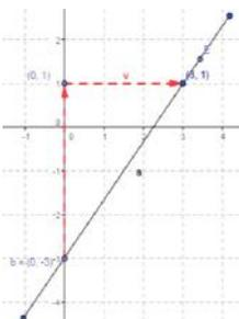
**Paso 5** Se unen los puntos formados por la ordenada al origen (0,-3) y el desplazamiento (3,1), con lo que se forma la recta que pertenece a la ecuación  $y = \frac{4}{3}x - 3$ .
